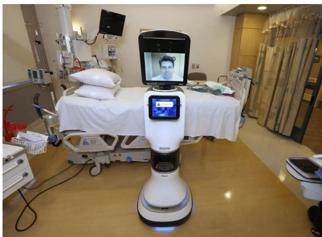
1.5 - сурет – RP – VITA телекөрсеткіш робот
